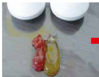
主剤と硬化剤を同量出す。
